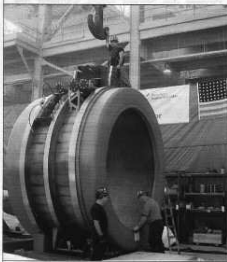
Generator von American Superconductor Mit 36 Megawatt Leistung der weltgrößte Stromerzeuger mit Supraleitungen
