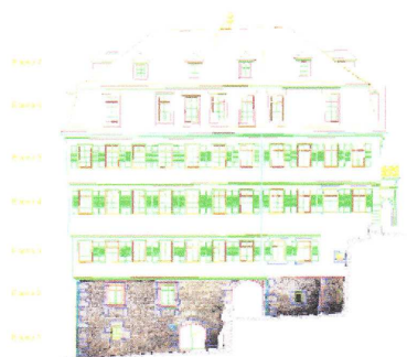
Alte Aula in Tübingen. Ostfassade. Bauaufnahme 2003 mit hinterlegten Orthofotos des Bruchsteinsockels. (Quelle: M. Hermann)
